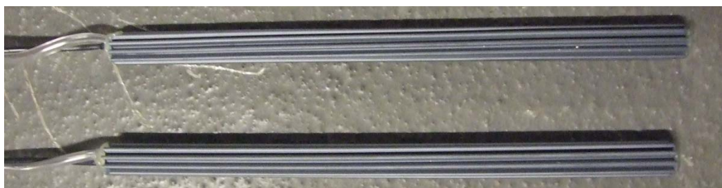
Figur 31 Insticksanod av märket Ebonex Plus från Vector. Anodlängd 200 mm och diameter 12 mm
