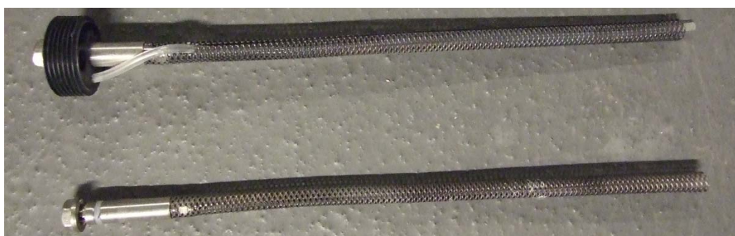
Figur 32 Instickselektrod av märket DurAnod 3 från Force. Den övre anoden används vid vertikal montering i innertak. Anodlängd 250 mm och diameter 8 mm
