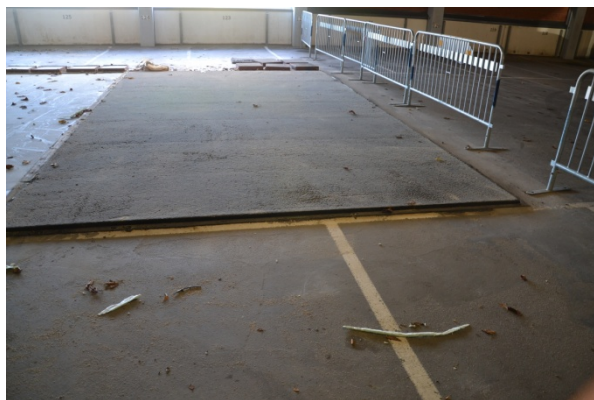
Figur 7 Färdig provyta (t v) och provplatta för slitageprovning (t h) (Foto: Y Edwards)
