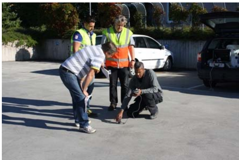
Figur 37 Mätning av korrosionshastighet genomförs (Swerea KIMAB, CBI och Weber). Rapicorr och galvanopuls, utrustning från CBI respektive Weber används. I bakgrunden skimtar stödmuren från figur 36 (Foto: CBI)
