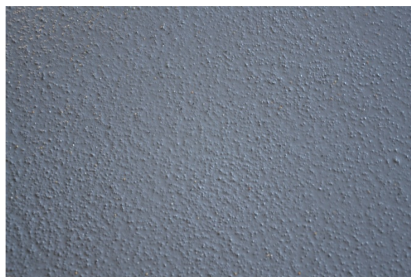
Figur 18 Färdig grå provyta med Deckshield ID från Flowcrete (Foto: Y Edwards)
