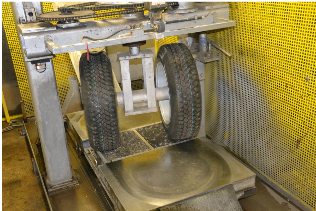
Figur 39 Utrustning för provning av Scuffing resistance, med dubbdäck (Foto: Y Edwards)
