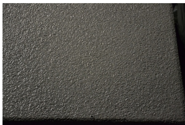
Figur 28 Färdig provyta med Mapefloor PU Flexibinder samt provplatta (Foto: Y Edwards)
