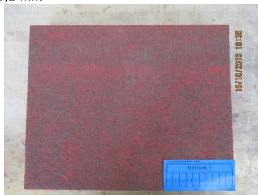
Figur 41 Viktförlust för härdplasten (polyurea). Totalt cirka 1,1 mm
