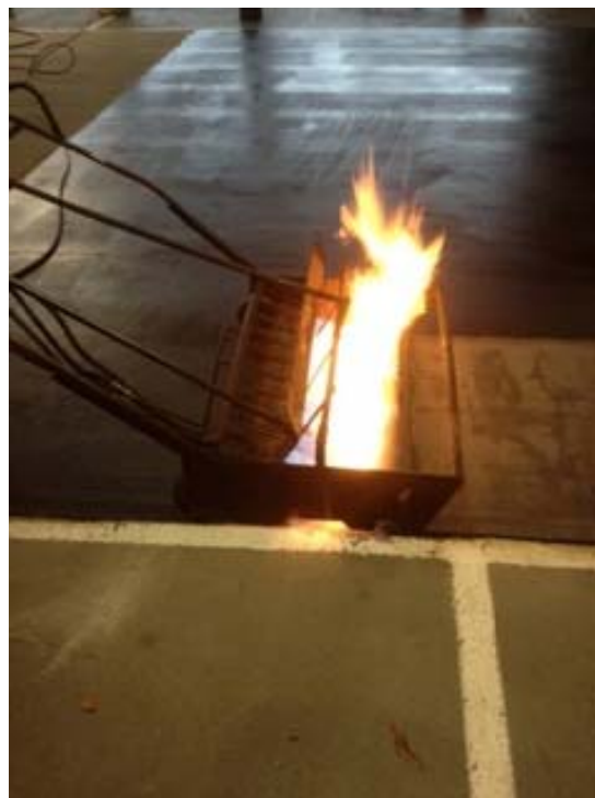
Figur 6 Provyta behandlad med bitumenprimer (t v) och svetsapplicering av matta (t h) (Foto: Duo Asfalt)
