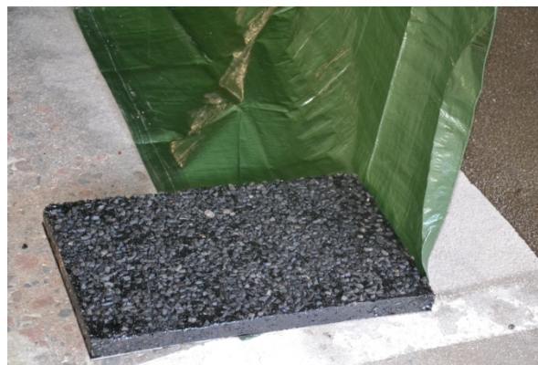
Figur 7 Färdig provyta (t v) och provplatta för slitageprovning (t h) (Foto: Y Edwards)
